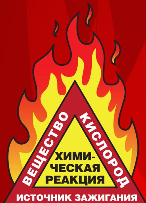
**ГОРЕНИЕ** — это химическая реакция, которая возникает при наличии трех обязательных составляющих, образующих так называемый «треугольник огня». Ими являются: горючее вещество, окислитель (кислород воздуха) и источник зажигания (горящая спичка, искра, открытое пламя). Для прекращения горения необходимо исключить хотя бы один из трех компонентов «треугольника огня».
